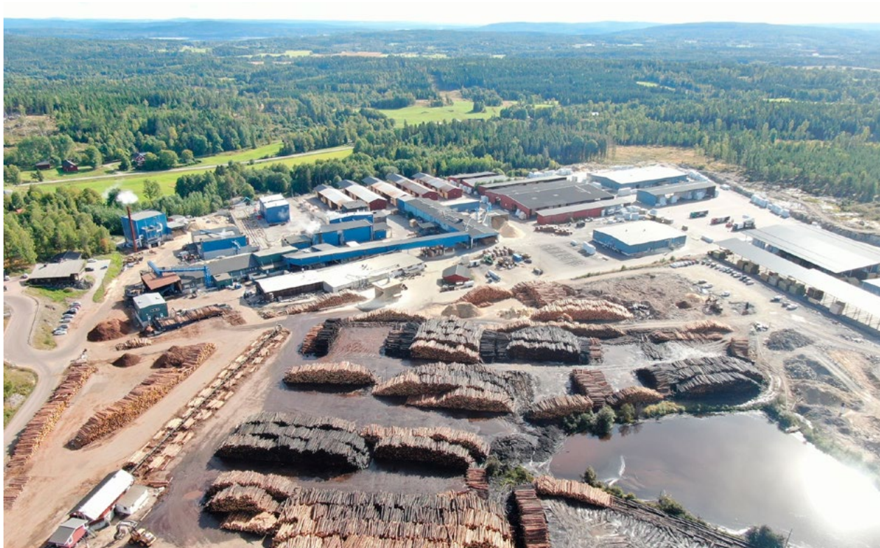
Spån och bark används för egen energiproduktion i värmepannan vid anläggningen i Korterud. Foto: Hilmer Andersson.
